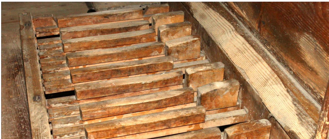
Foto č.7: Detail opotřebení náklížků pedálové klaviatury, opotřebení prahu výplně
